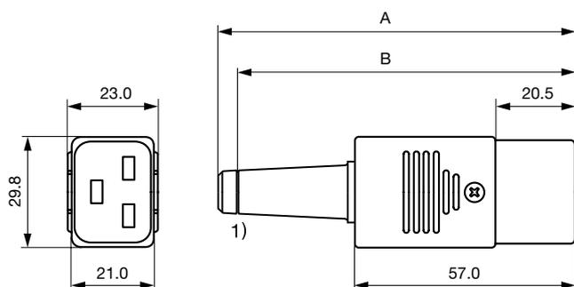
1) Knickschutztülle 8 (10) mm hier schneiden für 10 mm Kabel
